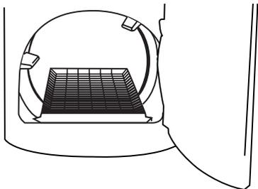
2. Aligner les deux crochets situés à l'avant de la grille de séchage avec les trous situés dans l'ouverture de la porte de la sècheuse et les insérer complètement dans les trous en appuyant. Placer le support arrière sur le rebord arrière de la sècheuse.
