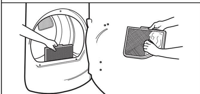
Nettoyer le filtre à charpie avant chaque charge. Enlever le filtre à charpie en le tirant tout droit vers le haut. Retirer la charpie du filtre en la roulant avec les doigts. Ne pas rincer ni laver le filtre pour enlever la charpie. La charpie mouillée s'enlève difficilement. Remettre le filtre à charpie fermement en place en l'enfonçant.
